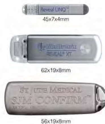
Figura 1: Um ILR é um pequeno aparelho eletrónico que é capaz de gravar continuamente a atividade cardíaca e detetar arritmias. Apresenta dimensões inferiores às de uma pen drive e é implantado subcutaneamente.
